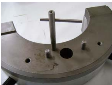
Pino de travamento instalado
