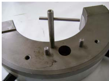
Pino de travamento instalado
